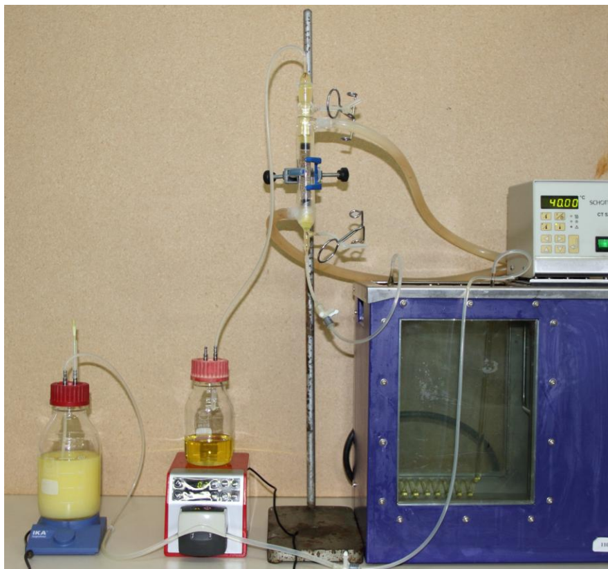
Figura A. Visão geral do aparato experimental para a síntese contínua de biodiesel em reator de leito empacotado.
