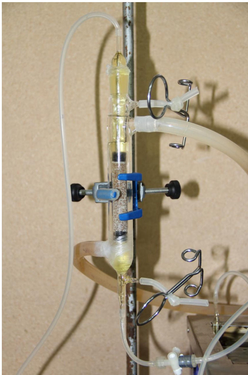
Figura C. Reator de leito empacotado preenchido com combi-lipase (CALB + RML + TLL).
