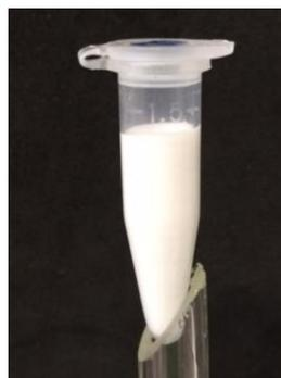
Figura 10 – NAZA após teste de centrifugação (3.000 rpm por 30 minutos)
