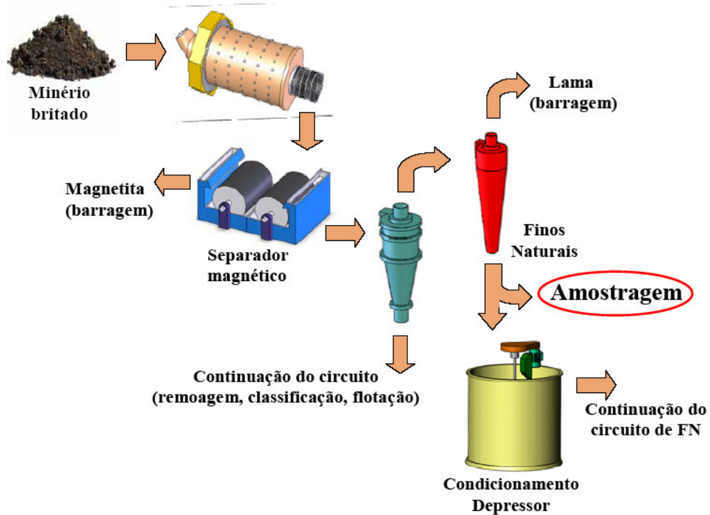
Figura 3.1. Ponto de coleta da amostra de Finos Naturais na usina de concentração.
