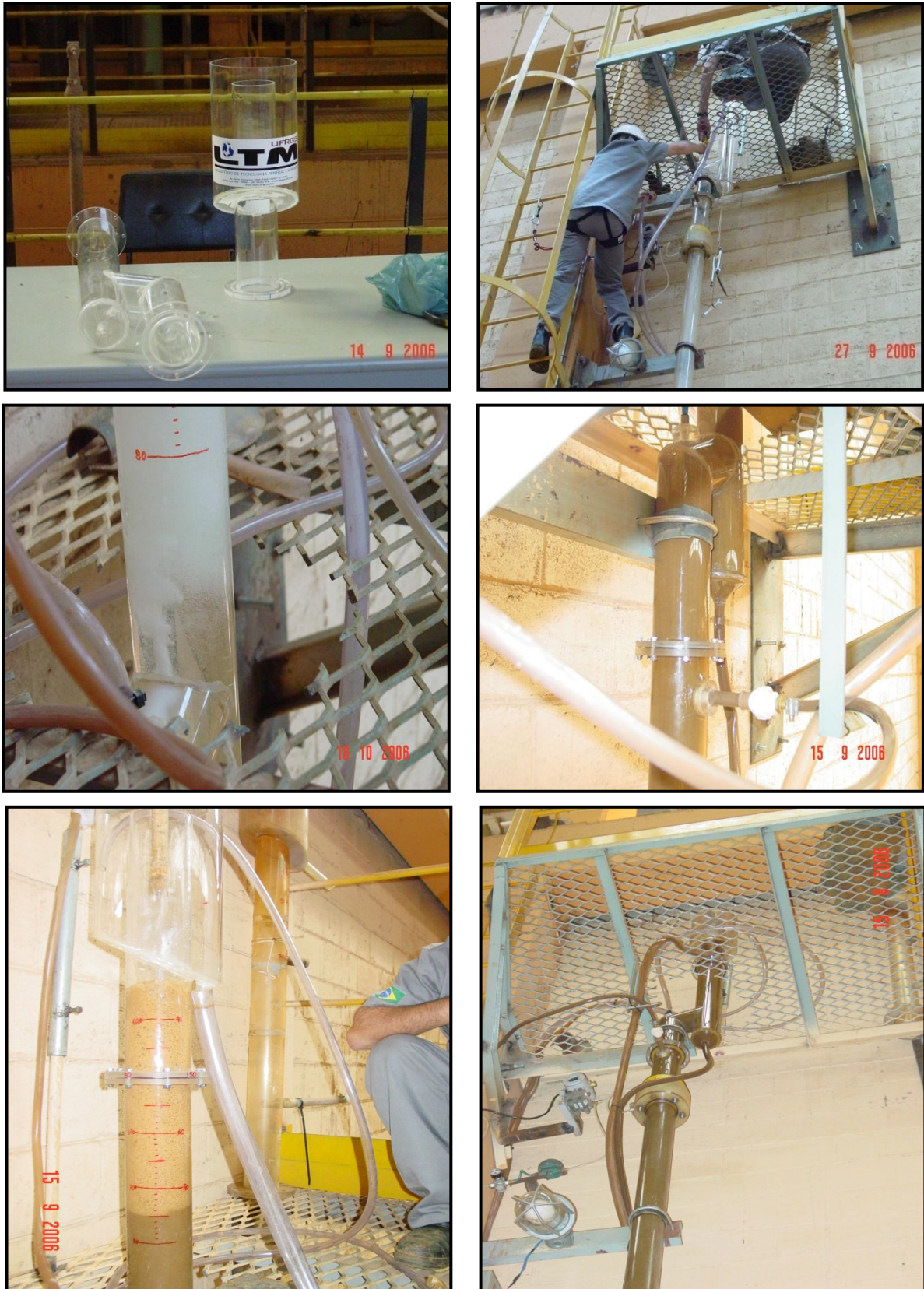
Figura 3.12. Coluna modificada de três produtos piloto (4"). Seqüência de montagem e detalhes da zona de inflexão. Coluna operando em sistema bi-fásico (líquido/ar) e em sistema tri-fásico (sólido/líquido/ar).
