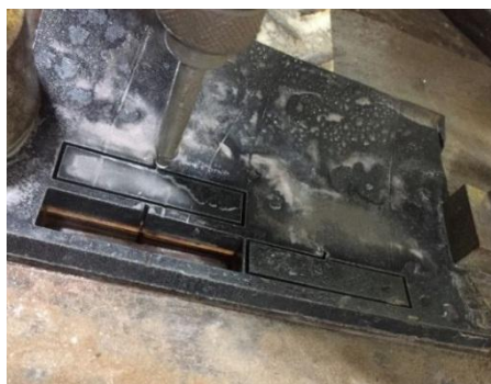
Figura A.1: Procedimento de corte através de jato de água
