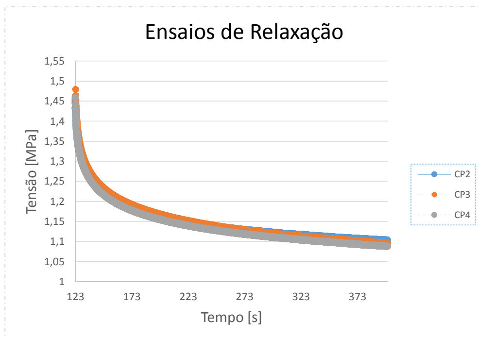
Figura 4.1: Resultado do ensaio de relaxação
