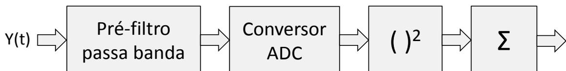
**Figura 2.11: Detector por energia (ATAPATTU; TELLAMBURA; JIANG, 2014).**
