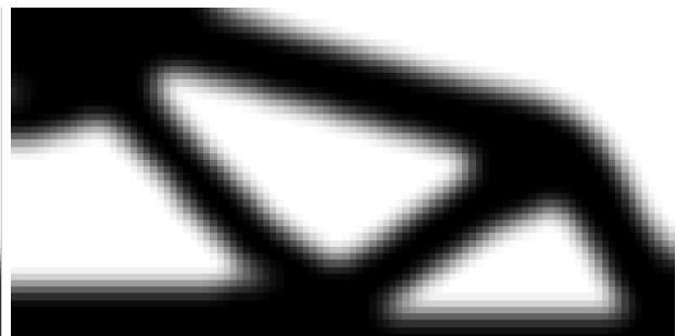
Figura 5.2 Viga MBB com microestrutura
