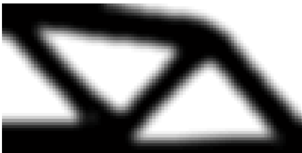
Figura 5.1 Viga MBB com microestrutura
