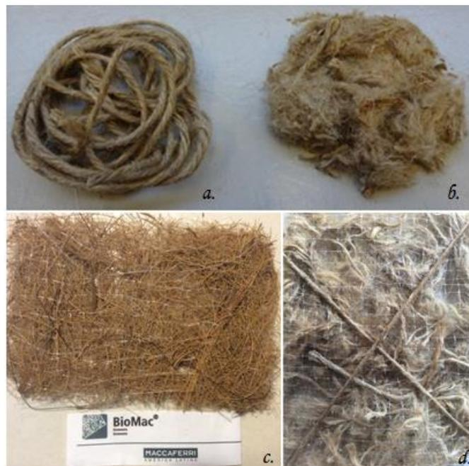
**Figura 11**– Mantas antierosivas utilizadas no experimento e sua composição. a. Barbante de sisal bruto, forma original do resíduo, forma que é disposta nas áreas degradadas da FUPASC; b. Sisal triturado. c. BioMac® 450 de fibra de coco, comercializada pela empresa MACCAFERRI. d. Biomanta de sisal produzida artesanalmente com resíduos na forma de cordão e triturado, oriundos de empresas do ramo fumageiro.
