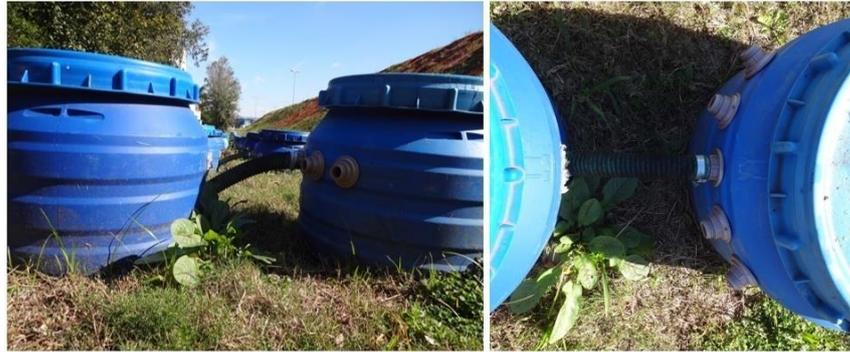
**Figura 8** - Sistema de coletores com o segundo reservatório acumulando 1/5 do material excedente do primeiro reservatório.
