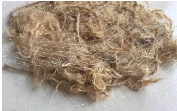
**Figura 12** – Imagem esquemática da manta de sisal (sisal triturado envolvido por tela fotodegradável).
