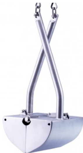
Figura 12: Draga do tipo van Veen.
