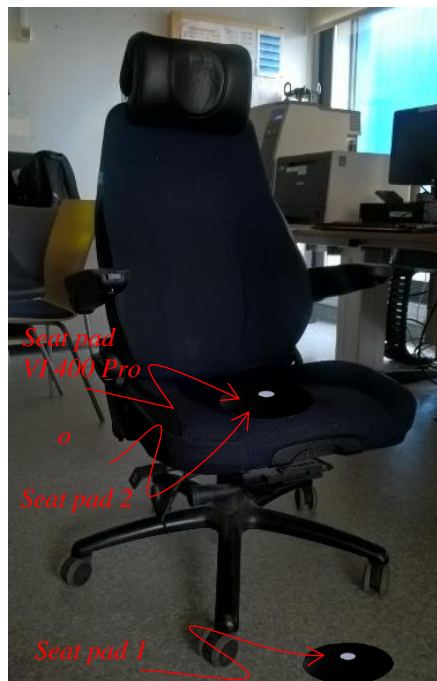
Figura 4.13 – Posiciones para mediciones con el sistema VI 400 Pro y con el sistema con dos seat pad .
