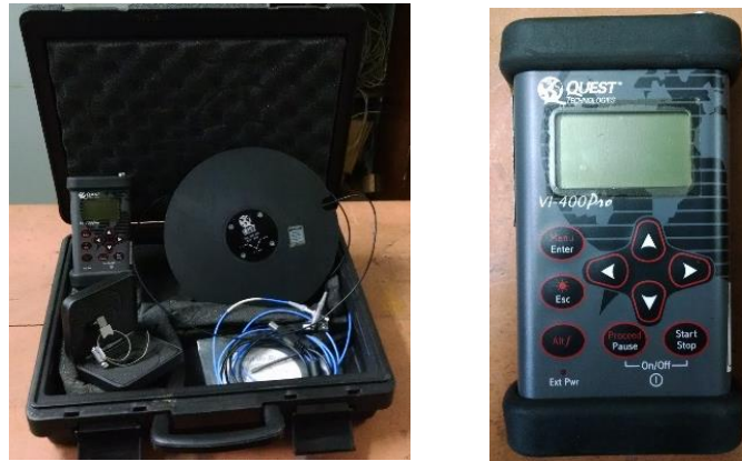
Figura 4.10 - Kit VI-400 Pro y equipos transductores utilizados en las mediciones.
