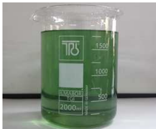
Figura 19. Lixiviado rico em íons ferrosos após 6 semanas em contato com o concentrado de pirita (Foto do autor, 2014).
