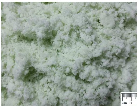
Figura 24. Cristais de melanterita precipitados com a proporção de 40% de etanol P.A.e 60% de lixiviado reduzido (condição C4) (Foto do autor, 2014).
