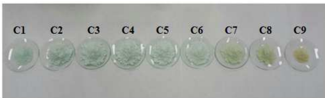
Figura 23 - Precipitação do sulfato ferroso heptahidratado na presença de etanol P.A. (99,5%) (Foto do autor, 2014).
