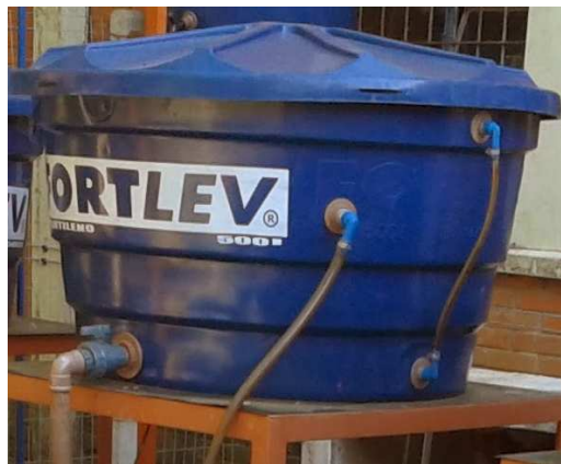
Figura 18. Caixa superior lacrada propiciando um ambiente redutivo (Foto do autor, 2014).
