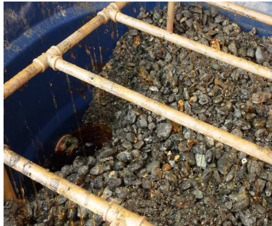
Figura 15. Lixiviação aeróbica para oxidar concentrado de pirita (Foto do Autor, 2014).
