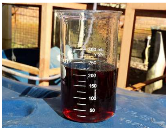
Figura 17. Lixiviado após 9 semanas contínuas de processo oxidativo (Foto do autor, 2014)
