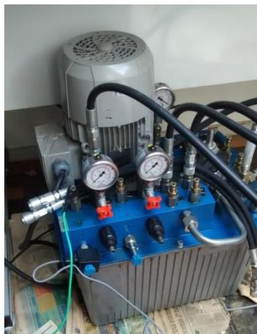
Figura C.3 - Unidade de Potência e Condicionamento Hidráulicos.
