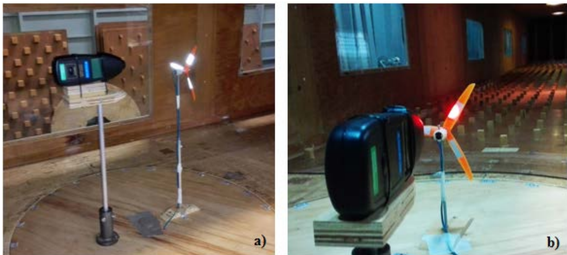
Figura 42 – Suporte do tacômetro para medição da velocidade angular do modelo: a) no eixo do túnel; b) na altura h=158,06 mm
