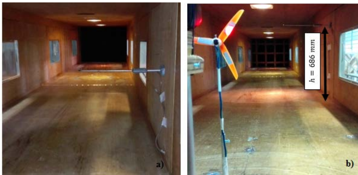
Figura 44 – Arranjo experimental do tubo Prandtl-Pitot: a) posição de instalação; b) altura em relação ao piso do túnel
