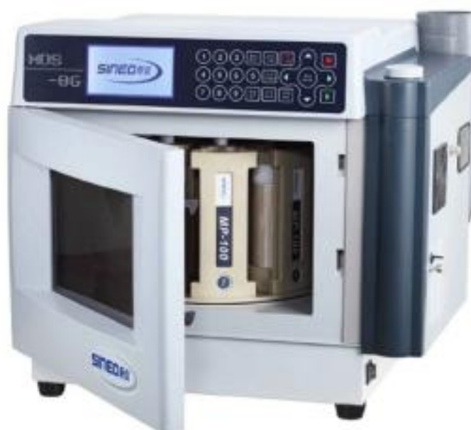
Figura 4.2 – Equipamento micro-ondas com sistema de digestão/extração que foi utilizado neste trabalho para o tratamento térmico das amostras sintetizadas.
