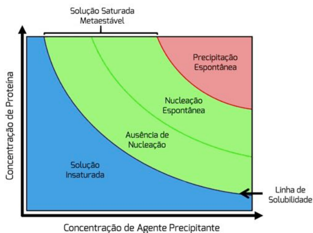
Figura 7-13: Diagrama de fase mediado por agente precipitante e concentração proteica para a cristalização.
