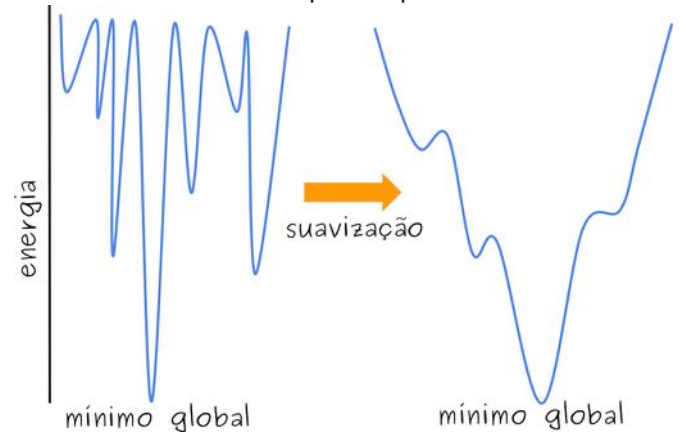
Figura 13-7: Efeito de suavização da superfície de energia.
