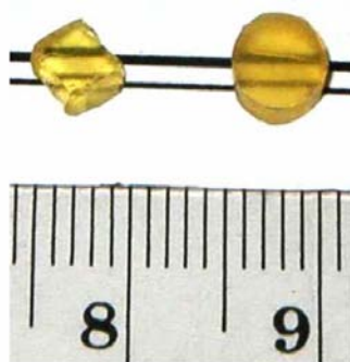
Figura 15: Foto dos compactos obtidos por Costa e colaboradores. À direita, a amostra compactada na forma cilíndrica; e, à esquerda, uma seção transversal de outro compacto do mesmo material.
