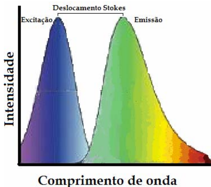
Figura 3: Ilustração das bandas de excitação e emissão; além do deslocamento de Stokes observado.
