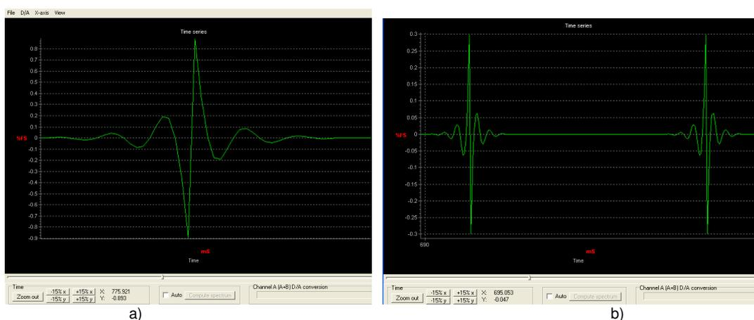
Figura 3.24 – a) Janela *Scope* do *Visual Analyser* mostrando a voltagem induzida pelo ímã abandonado em queda livre no procedimento acima citado. b) Esta é a mesma janela do gráfico (a), porém mostrando dois eventos de indução.
