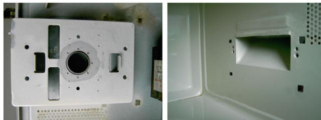
Figura 1.7 – a) A foto mostra o guia de ondas do lado externo do forno, onde o magnetron emite as microondas; b) mostra o guia de ondas na parte interna da câmara de cozimento com a tampa plástica retirada.
