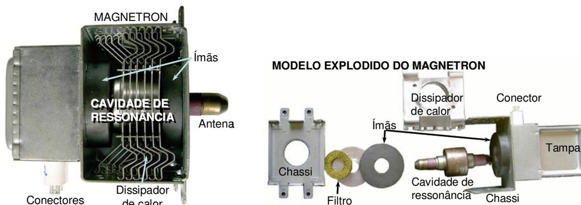
Figura 1.5 – (a) Foto de um magnetron montado;
