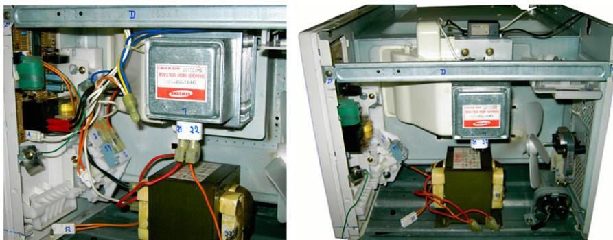
Figura 1.4 – Recomenda-se para leigos identificar as conexões com números e posição dos componentes com letras como mostram as fotos.
