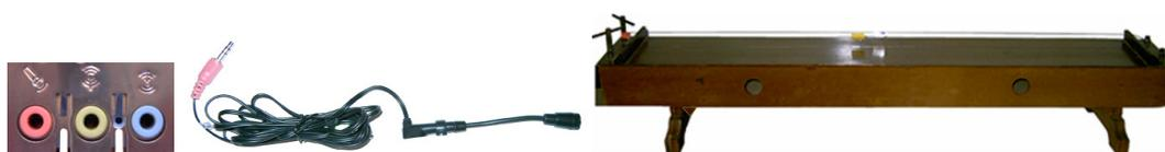
Figura 3.22 – Esquema de montagem dos equipamentos para medir a frequência das cordas da caixa de ressonância.
