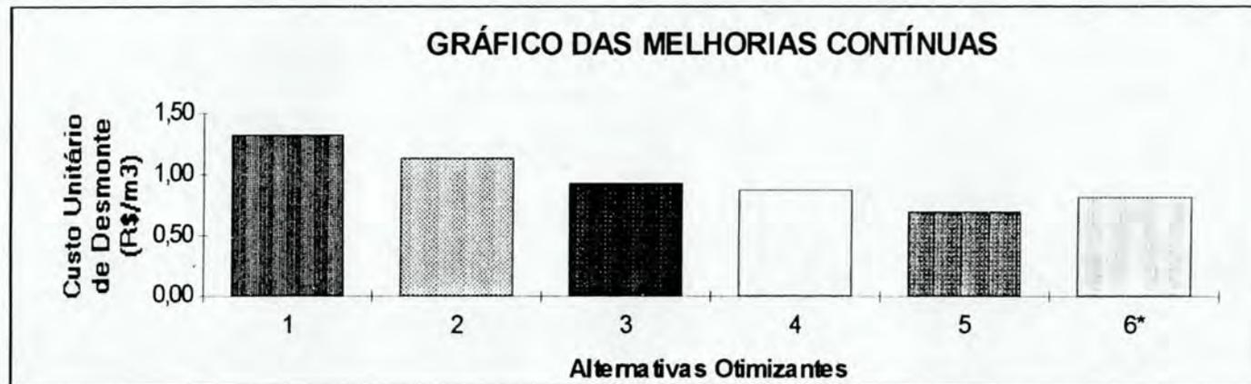
6\*- Foi imposta uma quantidade maior de explosivos por furo ( $q_p = 4,5$  kg/furo), em virtude do risco de que a alternativa 5 simulada não atenda a restrição relativa à fragmentação. Deste modo, a razão de carga ( $q^*$ ) não se afasta tanto do valor inicial.
