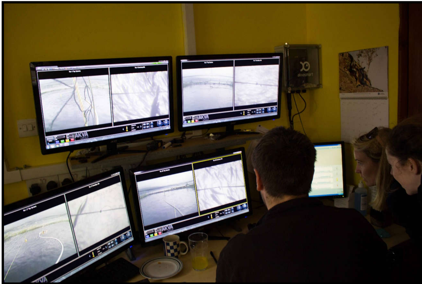
Foto 9- Sistema de informática utilizado para monitoramento da produção, qualidade da água e acionamento do processo de alimentação - fazenda de salmão da Marine Harvest em Loch Lihne, região oeste da Escócia.
