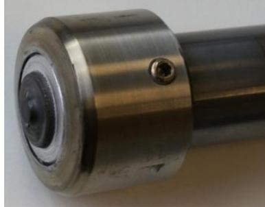
Figura 18 Ferramenta de soldagem em PCBN empregada para a produção das juntas.
