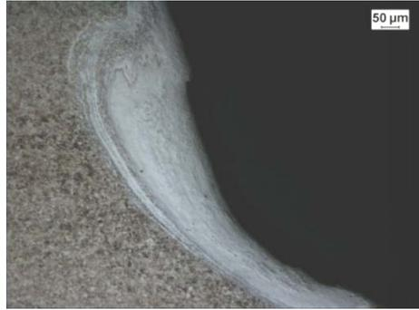
Figura 15 Mistura mecânica de material em um aço USIBOR 1500. Ataque Nital 1%. Parâmetros de soldagem utilizados: 1200 rpm, velocidade de penetração da ferramenta de 0,3 mm/s, tempo de mistura de 2s<sup>(54)</sup>.
