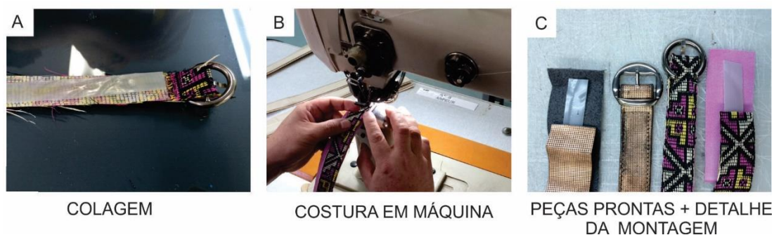
Figura 51 - Etapas da montagem de um cinto (peça-piloto 3)
