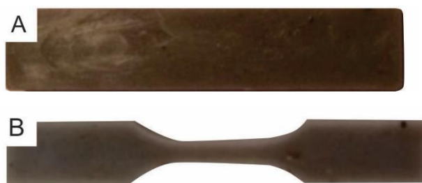
Figura 39 - Corpos de prova injetados para DMA e determinação de densidade (A) e tração (B)
