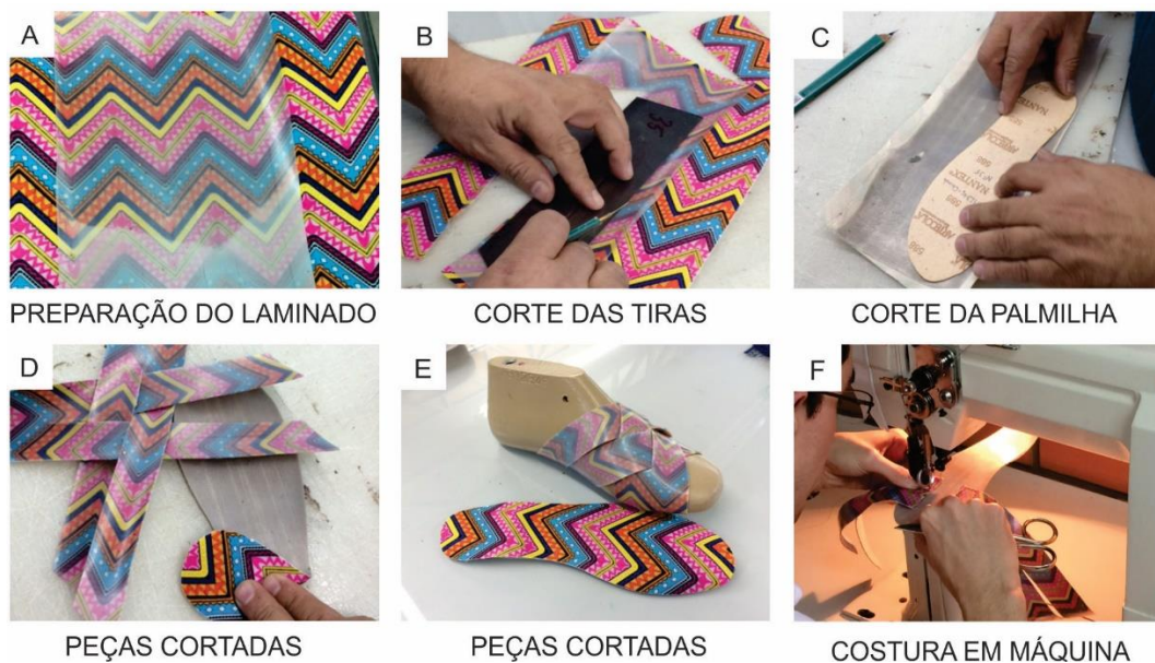
Figura 50 - Preparação do laminado em prensa pneumática e etapas da preparação de peças 1 e 2 para um chinelo
