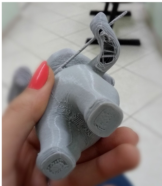
Figuras 44: Detalhe do problema da impressão 3D.
