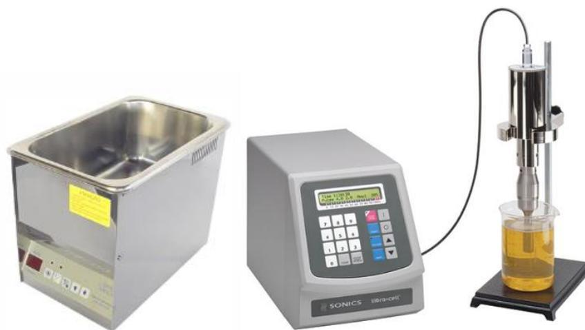
**Figura 13** - Tipos de equipamento de ultrassom: a) Ultrassom tipo banho (Ciencor 2016). b) Ultrassom tipo sonda (Sonics 2016)
