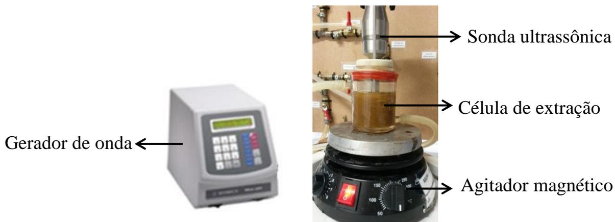
**Figura 15** - Gerador de ondas ultrassônicas e célula de extração de pectina da casca da manga.
