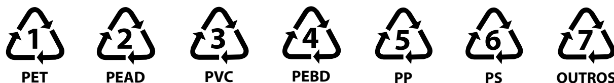
Figura 05 – Códigos de identificação de resinas poliméricas
