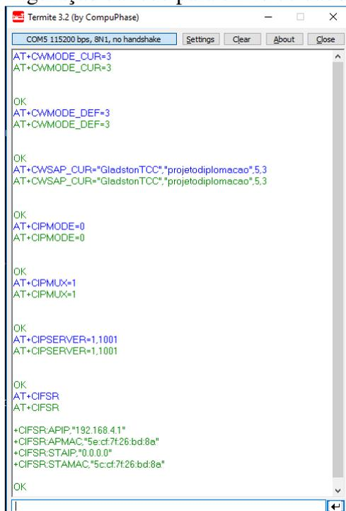
Em seguida foi configurado o modo de operação como servidor e cliente, definiu-se o nome da rede, senha, frequência, e tipo de segurança WPA2. Definiu-se a porta e finalmente se obteve um IP para conexão. Os comando feitos com sucesso são sempre respondidos com OK.
