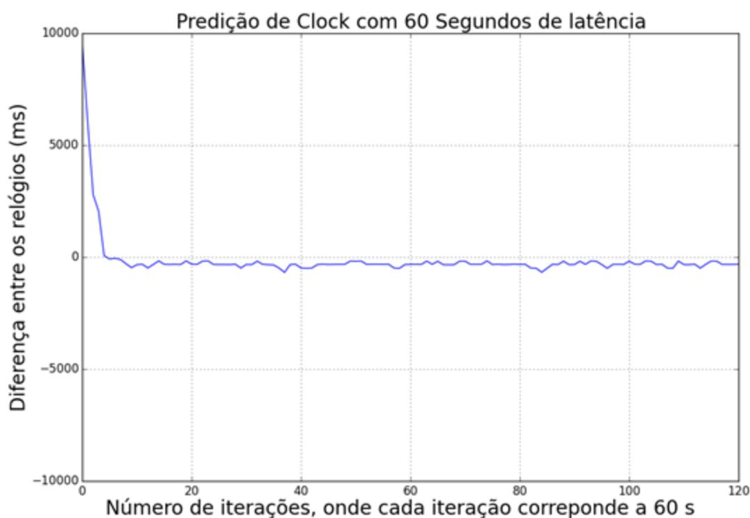
**Figura 36 Resultado do teste da Predição de relógio com 60 Segundos de latência**
