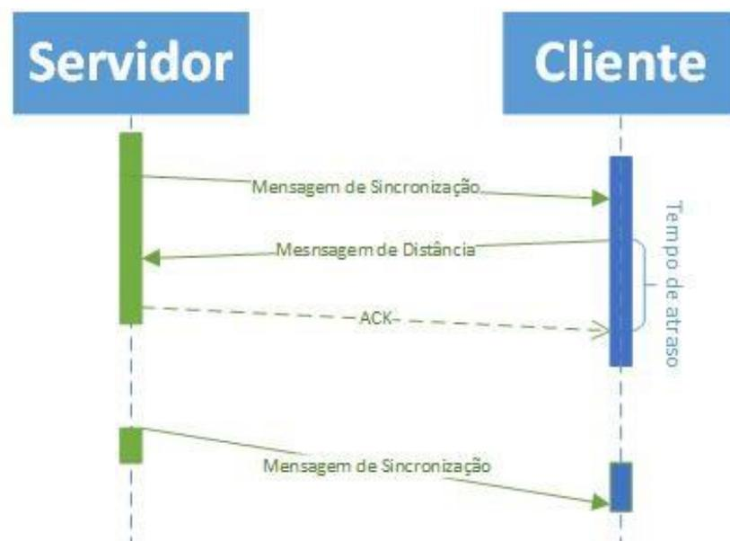
**Figura 10 Funcionamento do método para medir a distância.**
