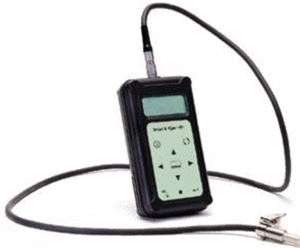
Figura 6.30 Ejemplo de dosímetro, equipo utilizado para medir dosis de ruido (Fuente: Universidad de Córdoba)
