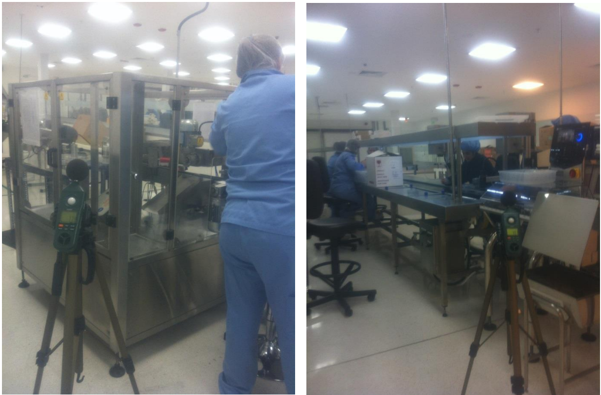
Figura 6.12 Fotografías del momento de toma de mediciones en el sector de empaque correspondientes a la M2, punto PB-EMP-05 y la M4, punto PB-EMP-03
