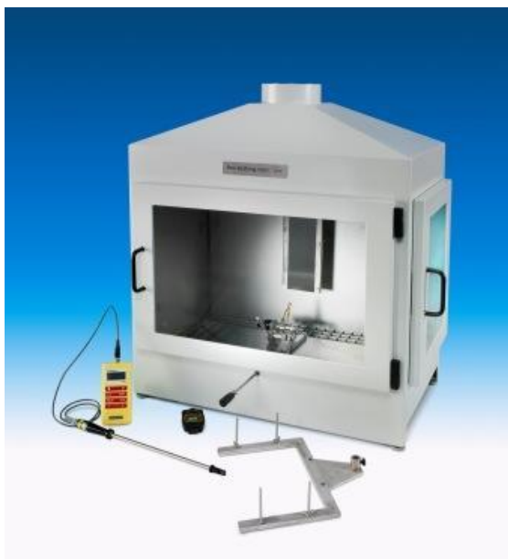
Figura 12: Equipamento para ensaio da ignitabilidade
