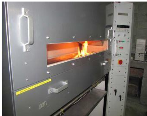
Figura 11: Ensaio da densidade crítica do fluxo de energia térmica em execução
