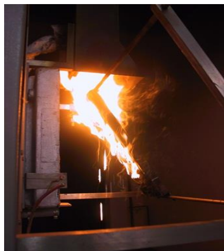
Figura 7: Ensaio de propagação superficial da chama
