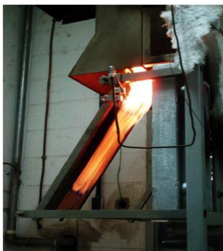
Figura 6: Aplicação da chama piloto
