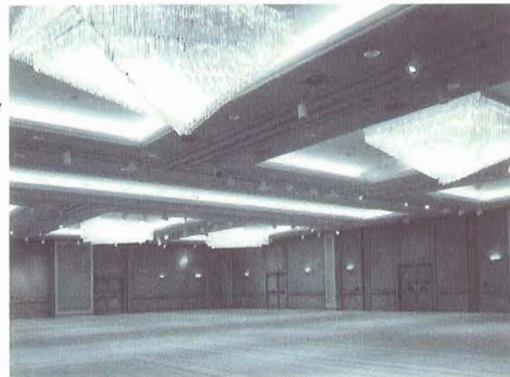
Figura 115 - Hyatt Regency, Oakland, Salão de banquetes com sistema flexível de iluminação conjugado a luminárias deslizes, dowlights, holofotes, plafons para ser arranjado como o requerido. (SAITO, 1988, p. 220).
