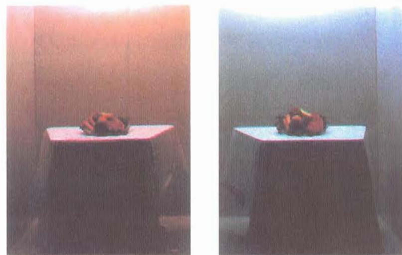
Figura 42 - À esquerda, lâmpada fluorescente de cor quente; e à direita, lâmpada fluorescente de cor fria (MICHEL, 1996,p.17).
