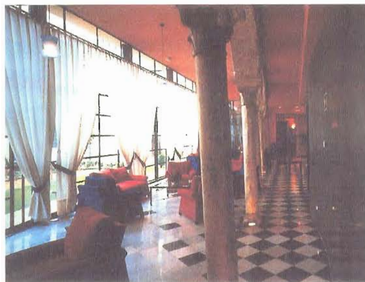
Figura 23- Hotel Los Seises, Sevilla, Espanha. Nota-se que as luminárias próximas às aberturas permanecem acesas, embora não seja necessário. Mais à direita, a iluminação artificial é realmente apropriada (BANGERT, 1993, p.95).
