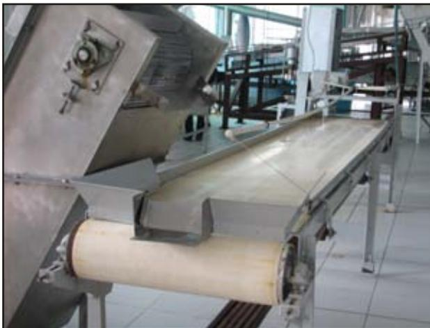
Figura 8: Esteira de Inspeção e Retoques
