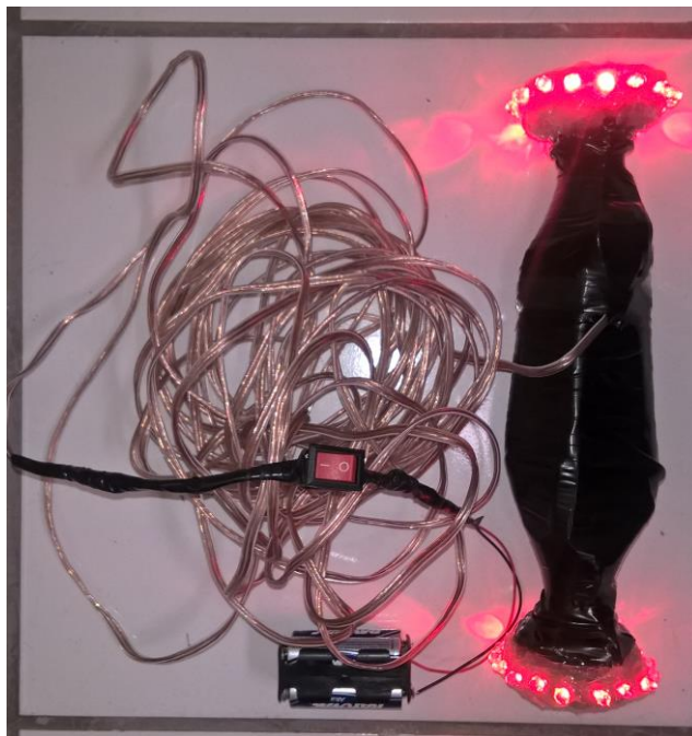
Figura 8 – Módulo eletrônico de sincronização utilizado para a sincronização das câmeras.
