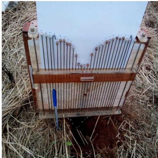
**Figura 3.** Representação do perfil do sulco de semeadura pelo perfilômetro.
