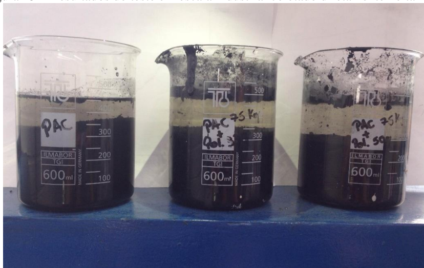
Figura 45 – Resultados do teste em escala industrial coletado diretamente no tanque de mistura
