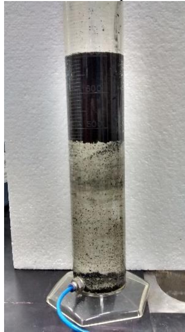
Figura 31 – Resultado do processo de FAD
