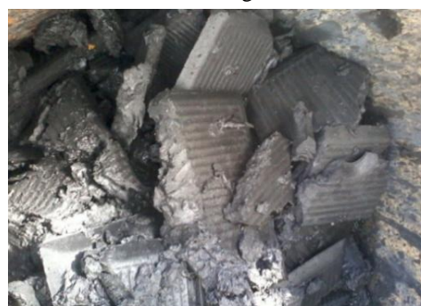
Figura 46 – Operação de filtração (em filtro prensa de placas e quadros) do lodo no tratamento do efluente oriundo da operação de forjamento aplicando lubrificante base água
