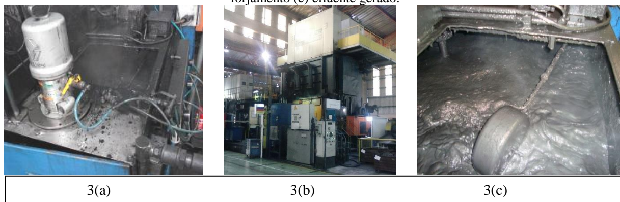
Figura 3 – Utilização de lubrificante na prensa e efluente resultante: (a) tanque de lubrificante; (b) prensa de forjamento (c) efluente gerado.
