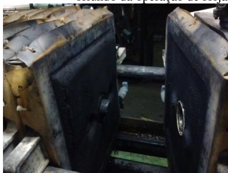
Figura 46 – Operação de filtração (em filtro prensa de placas e quadros) do lodo no tratamento do efluente oriundo da operação de forjamento aplicando lubrificante base água
