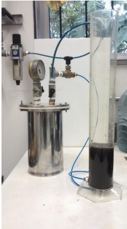
Figura 16 – Vaso saturador e célula de flotação utilizados nos ensaios
