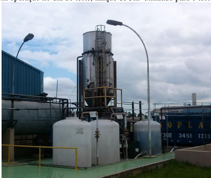
Figura 44 – Planta em operação no dia do teste, tanque de 5m 3 utilizado para o teste em escala industrial
