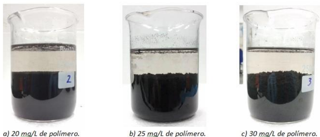
Figura 24 – Resultado da floculação com diferentes dosagens de polímero catiônico
