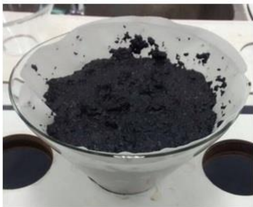
Figura 33 – Lodo gerado no tratamento do efluente estudado: (a) úmido após filtração e (b) após secagem a 60°C
