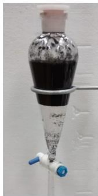
b) Efluente após coagulação-floculação.
