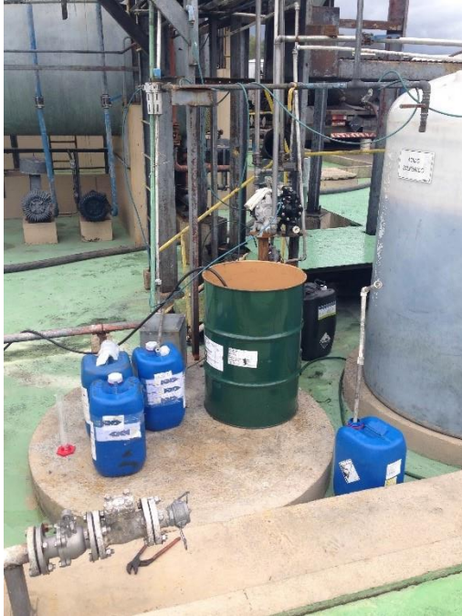
Figura 17 – a) Preparação de PAC e polímero para o teste em planta, b) tanque de quebra de emulsão.
