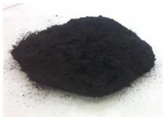
b) Lodo gerado após secagem a 60°C e destorroamento
