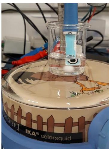
Figura 16. Foto da célula eletroquímica e do potenciostato utilizados.
