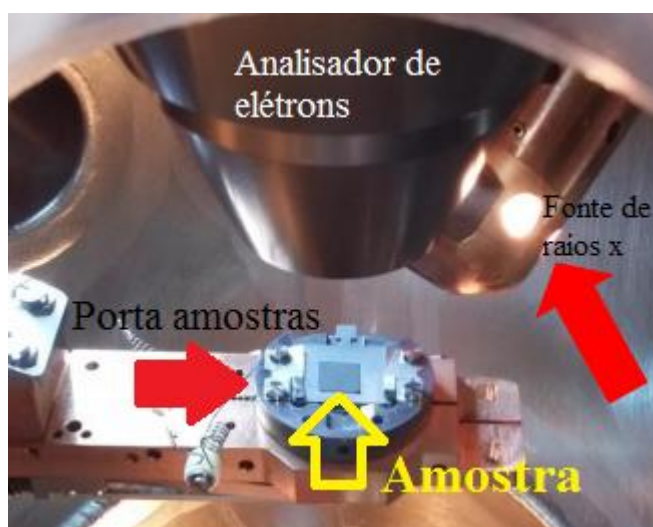
Figura 12: Foto tirada do interior da câmara de XPS usada para a coleta de espectros de fotoemissão.
