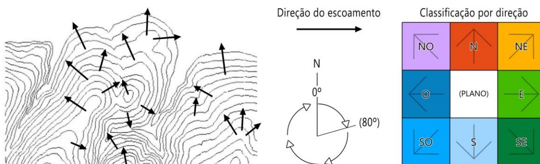
Figura 5.17 – Orientação das vertentes: (a) indicação da direção do escoamento sobre as curvas de nível, que é expressa em graus a partir de 0° (Norte); (b) classificação dos pixels em 9 classes (8 direções + "plano", i.e., sem escoamento) conforme direção do escoamento.
