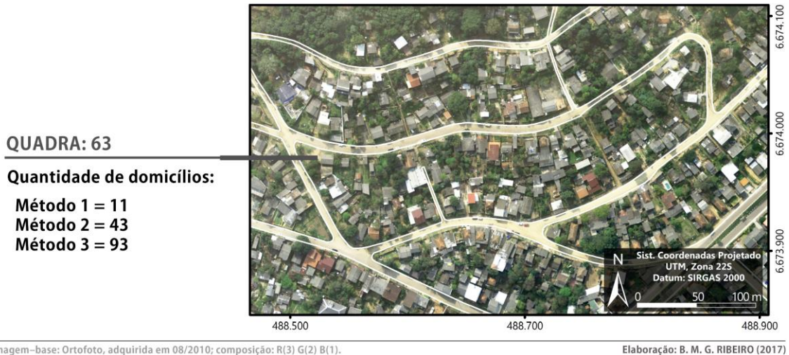
Figura 6.11 – Exemplo de discordância nos valores obtidos para cômputo da quantidade de domicílios por quadra, segundo os três métodos testados. A imagem orbital ao fundo dá evidências de que os resultados mais adequados são aqueles obtidos pela aplicação do Método 3.
