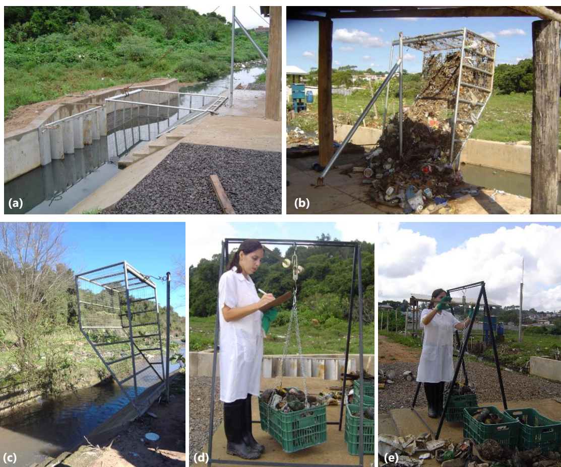
Figura 3.16 – Fotos do experimento de coleta e caracterização de resíduos sólidos da bacia Mãe d’Água por meio de armadilha construída em um córrego: em (a), armadilha em posição para operação; (b) operação de descarga de resíduos, após evento pluviométrico; (c) armadilha içada; (d) e (e) aferição volumétrica e pesagem de resíduos sólidos.
