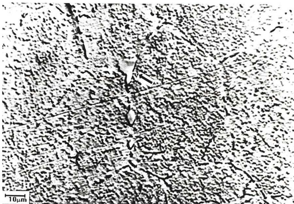
Figura 21 - Aspecto metalográfico para o primeiro tipo de ataque químico:aumento:1000X Ataque: Solução A + solução de Murakami.
