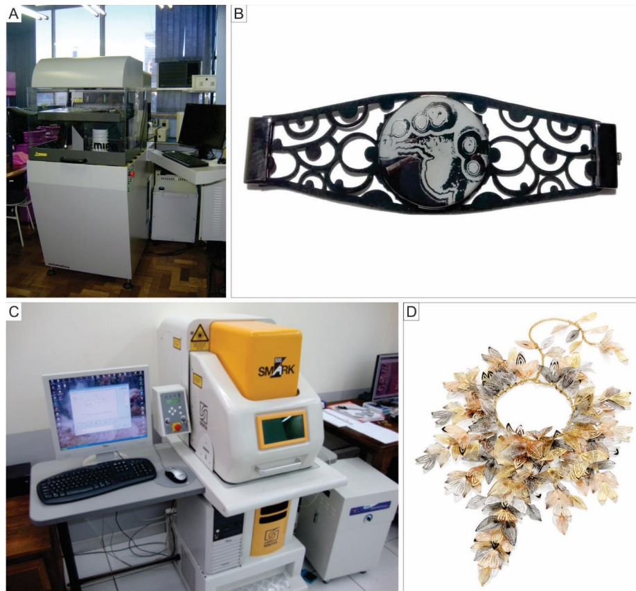
Figura 13 – Tecnologia Laser: (A) equipamento laser CO 2 para corte e gravação, (B) pulseira em couro cortado a laser, contendo, em seu ponto central, uma ágata com tingimento preto possuindo gravação, resultando em uma imagem contrastante; (C) equipamento laser YAG para corte e gravação de metais; (D) colar em ouro (AU 18K) amarelo, rosa e branco cortado a laser, designer Eliânia Rossetti, peça premiada no concurso AuDITONS 2012.
