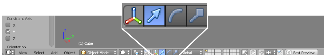
Figura 72 – Localização do botão que mostra ou oculta a visualização do Gizmo e os que alternam entre os três tipos de Gizmo .
