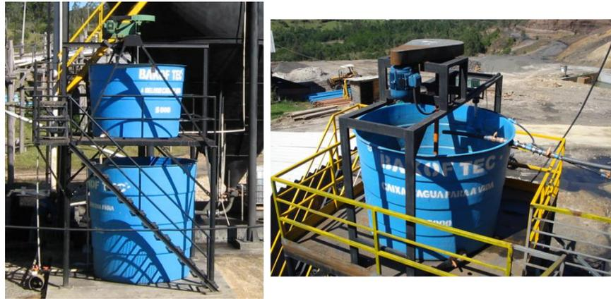
Figura 22 - Estação de preparo de solução floculante.
