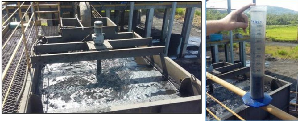
Figura 29 - Tanque condicionamento da polpa com floculantes.
