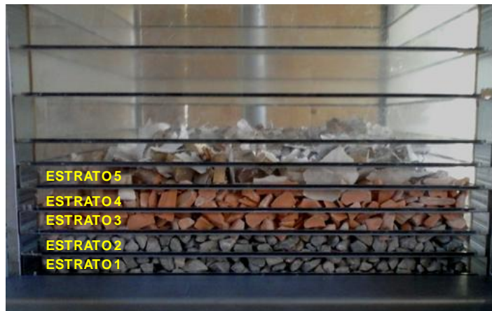
Figura 30: Configuração do leito utilizada nos ensaios. Quantidades selecionadas de contaminantes foram adicionadas a uma mistura binária de concreto e material cerâmico.
