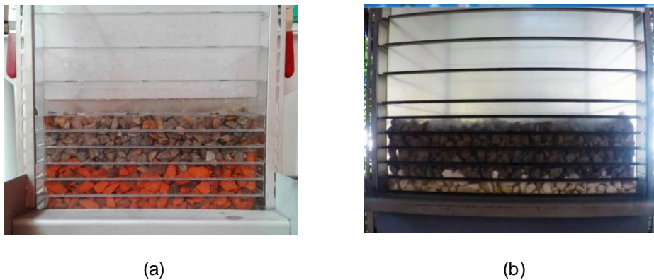
Figura 24: (a) Configuração inicial do leito no ensaio no jigue hidráulico. (b) Configuração inicial do leito no ensaio no jigue pneumático.
