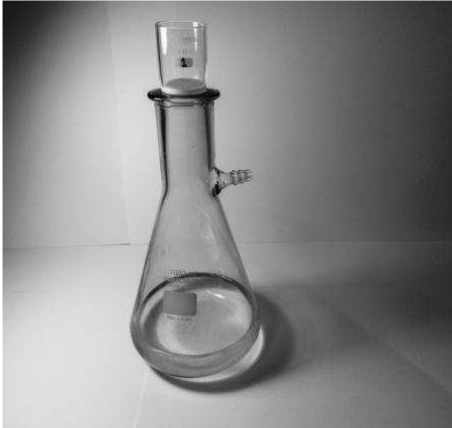
Figura 16: Sistema para determinação de CO 2 , etapa de filtração.
