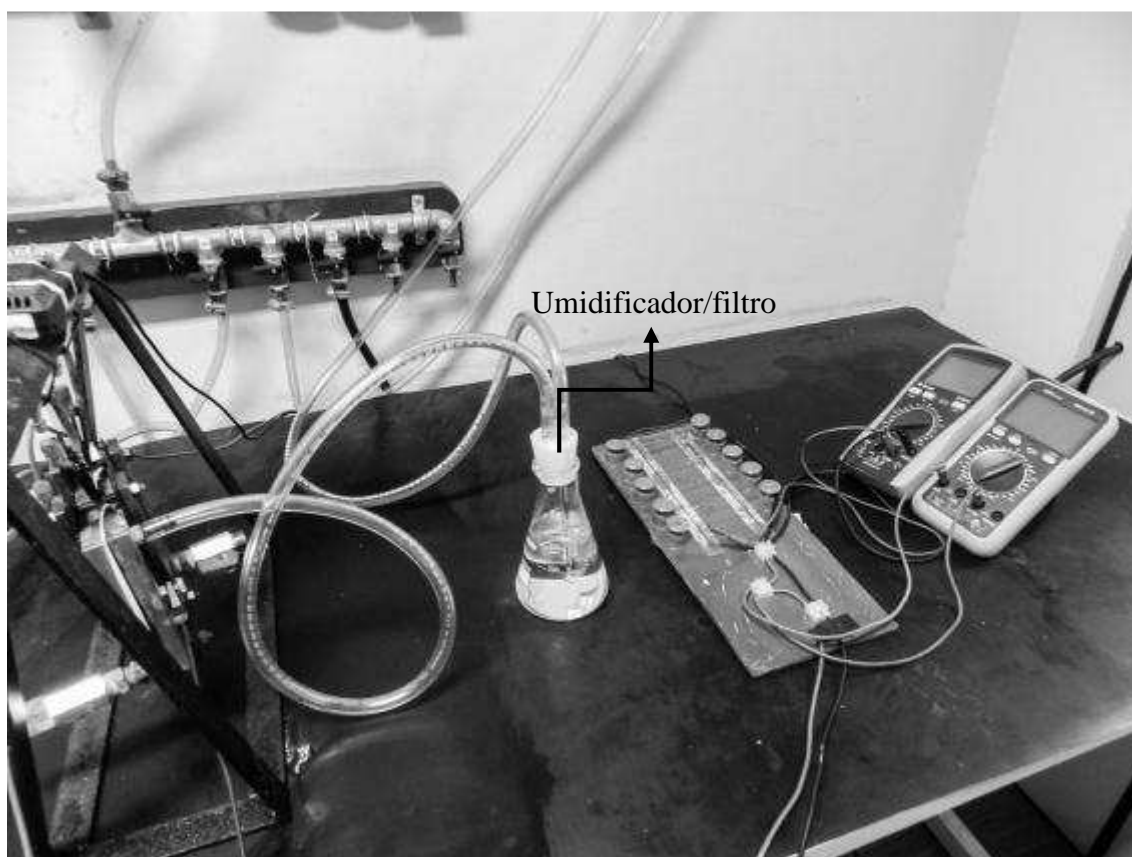
Figura 11: Sistema de umidificação.
