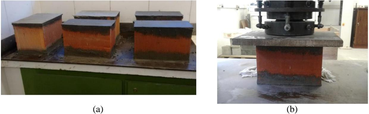
Figura 19 – (a) Capeamento dos blocos cerâmicos para ensaio de resistência à compressão. (b) Posicionamento na prensa para realização do ensaio.
