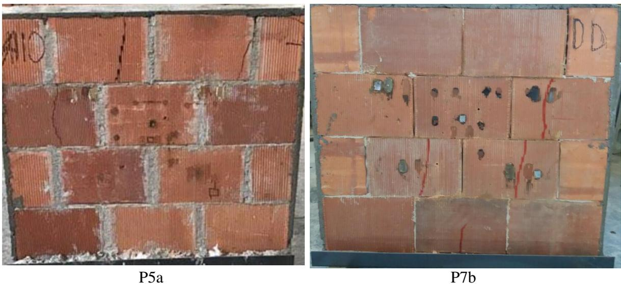
Figura 39 – Padrão de fissuração das amostras na face oposta ao aquecimento.
