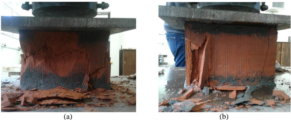
Figura 32 – Ruptura à compressão de blocos de (a) paredes maciças
