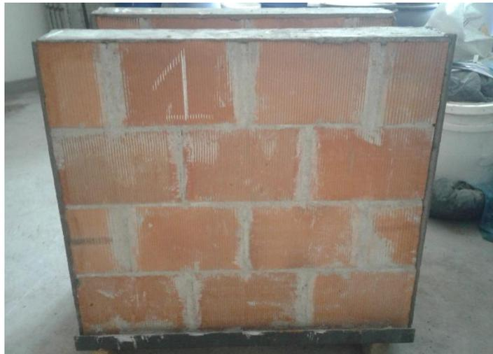
Figura 24 – Capeamento superior e lateral das amostras.
