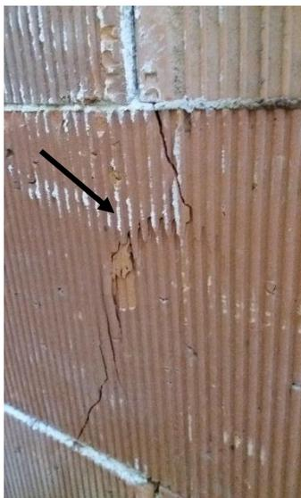
Figura 69 – Fissura na face exposta observada após ensaio – amostra P6a.
