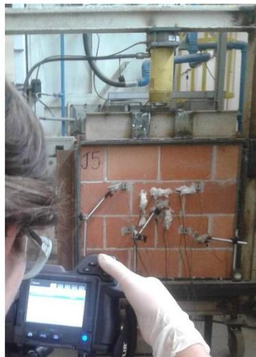
Figura 31 – Preparação de câmera para captação de imagens termográficas.
