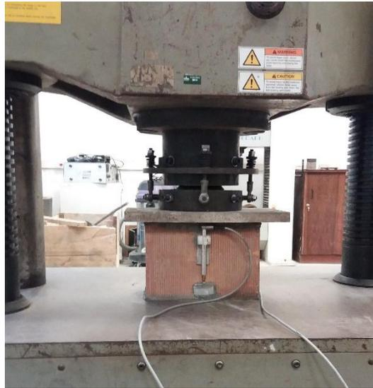
Figura 21 – Ensaio de determinação do módulo de elasticidade dos blocos cerâmicos.
