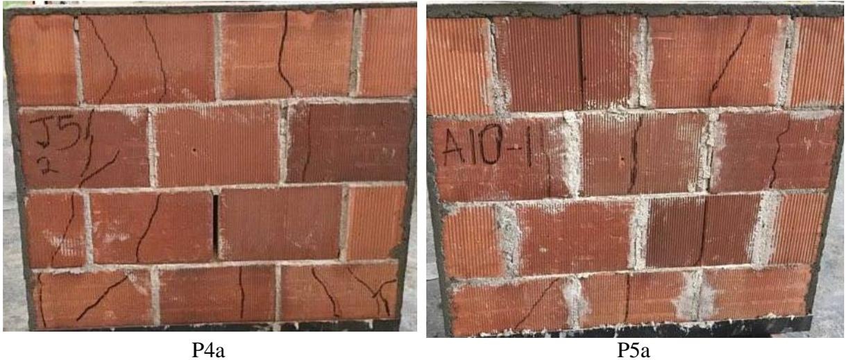
Figura 38 – Padrão de fissuração das amostras na face exposta às altas temperaturas.
