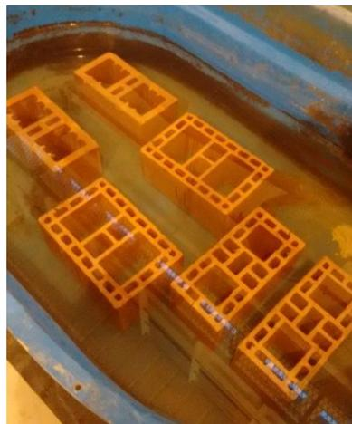
Figura 20 – Amostras de blocos cerâmicos imersos em água para determinação do índice de absorção d'água (AA).
