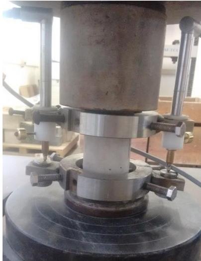
Figura 18 – Determinação do módulo de elasticidade das argamassas.
