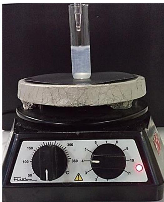
**Figura 3.5:** Gotejamento de solução de P(3HB) em não-solvente.
