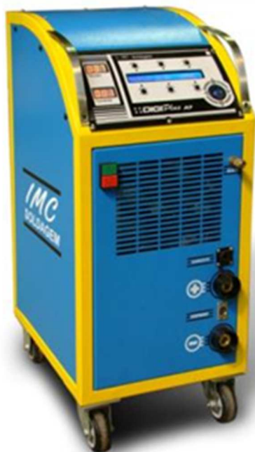
Figura 46 – Fonte de potência utilizada na soldagem (Digiplus A7 450).
