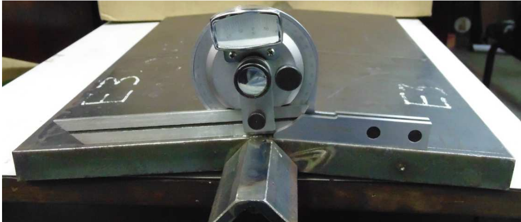
Figura 39 – Posição do goniômetro mostrando o contato regular entre as superfícies das réguas e as superfícies das chapas.
