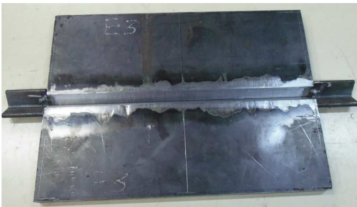
Figura 48 – Corpo de prova preparada para ser soldada (junta a topo).
