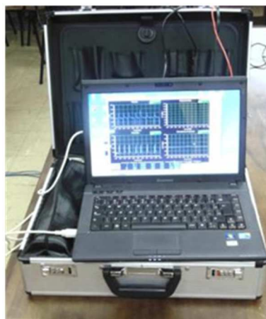
Figura 42 – Sistema de aquisição de parâmetros soldagem (corrente, tensão e velocidade de alimentação de arame) da IMC.
