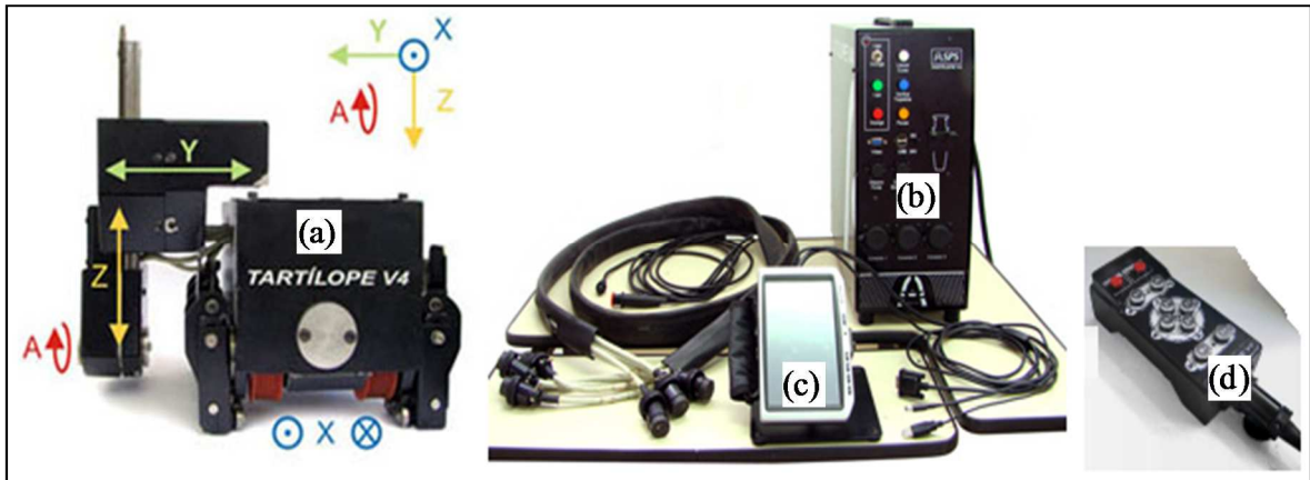
Figura 47 – Sistema automatizado de soldagem (Tartilope V4), sendo (a) manipulador de tocha, (b) gabinete de controle, (c) interface homem-máquina e (d) controle de posicionamento de tocha (LABSOLDA).
