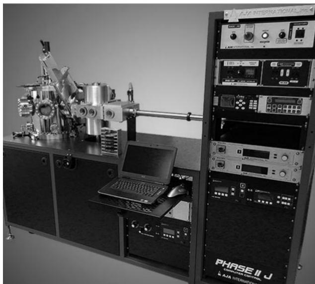
Figura 10: Equipamento ATC ORION 8 UHV em que foram produzidos os filmes finos.
