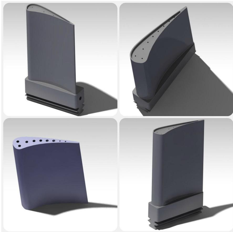
Figura 1.1 - Esquema de un álabes C3X (vane) con 10 conductos circulares de refrigeración
