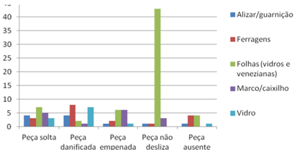
Figura 69 - Esquadrias (janelas) - especificação da falha
