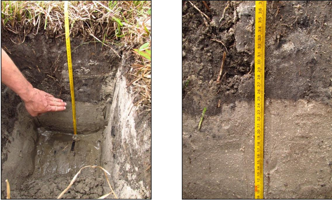
**Figura 22** - Neossolos quartzênicos no balneário Camacho: trincheira de 40 x 40 e 60 cm de profundidade (contato com o lençol freático) em que se pode observar a grande presença de material arenoso ao longo do perfil.
