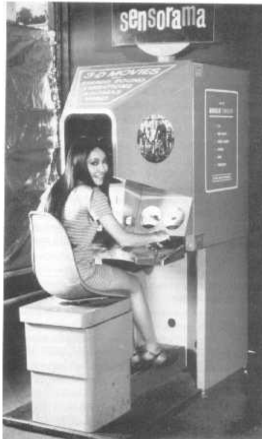
Figura 3. Sensorama, simulador baseado em vídeo.
