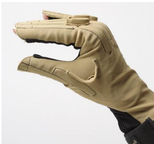
Figura 13 Luva rastreadora de posição dos dedos.
