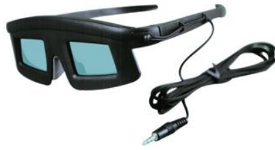
Figura 10 Dispositivo de visualização conhecido como shutter glasses .
