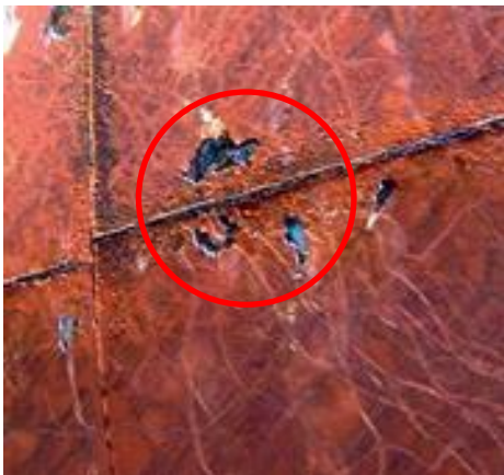
Figura 1.1 - Exemplo de corrosão em de navios.
